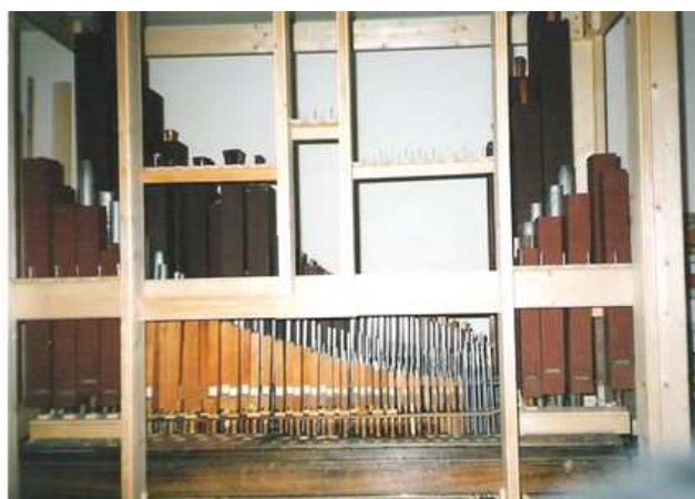
construction du buffet : la façade (faux-tuyaux en bois peint pour les plate-faces médianes) et détail d'une claire-voie
