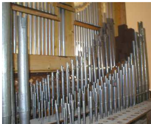
le buffet terminé, on aperçoit les tuyaux du prestant, et première mise en place des tuyaux de métal
