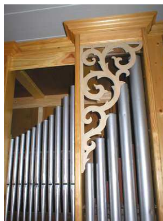
construction du buffet : la façade (faux-tuyaux en bois peint pour les plate-faces médianes) et détail d'une claire-voie
