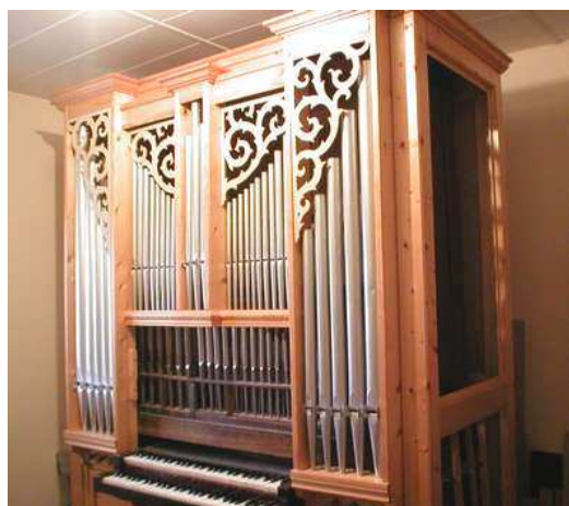
le buffet terminé, on aperçoit les tuyaux du prestant, et première mise en place des tuyaux de métal
