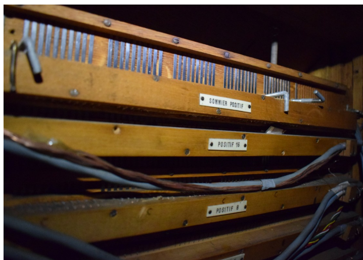
Figure 36: détail des peignes et des lamelles d'argent
